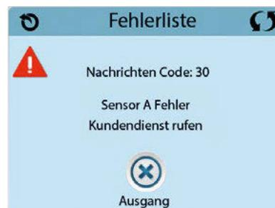
*\* Manche Nachrichten können auf dem Bedienfeld zurückgesetzt werden. Fehlermeldungen, die zurückgesetzt werden, können erscheinen mit einem „Clear“ am Ende der Nachricht. Drücken Sie auf den „Clear“, um die Meldung zurückzusetzen.*
