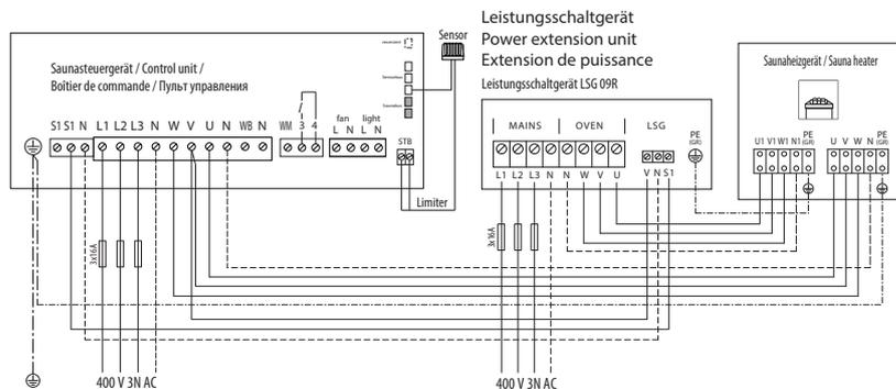
\* Umverdrahtung auf einkreisige Variante möglich, bei Verwendung eines Steuergerätes mit Zulassung für eine Leistung von 10,5 kW bei max. Phasenbelastung 16 A.
